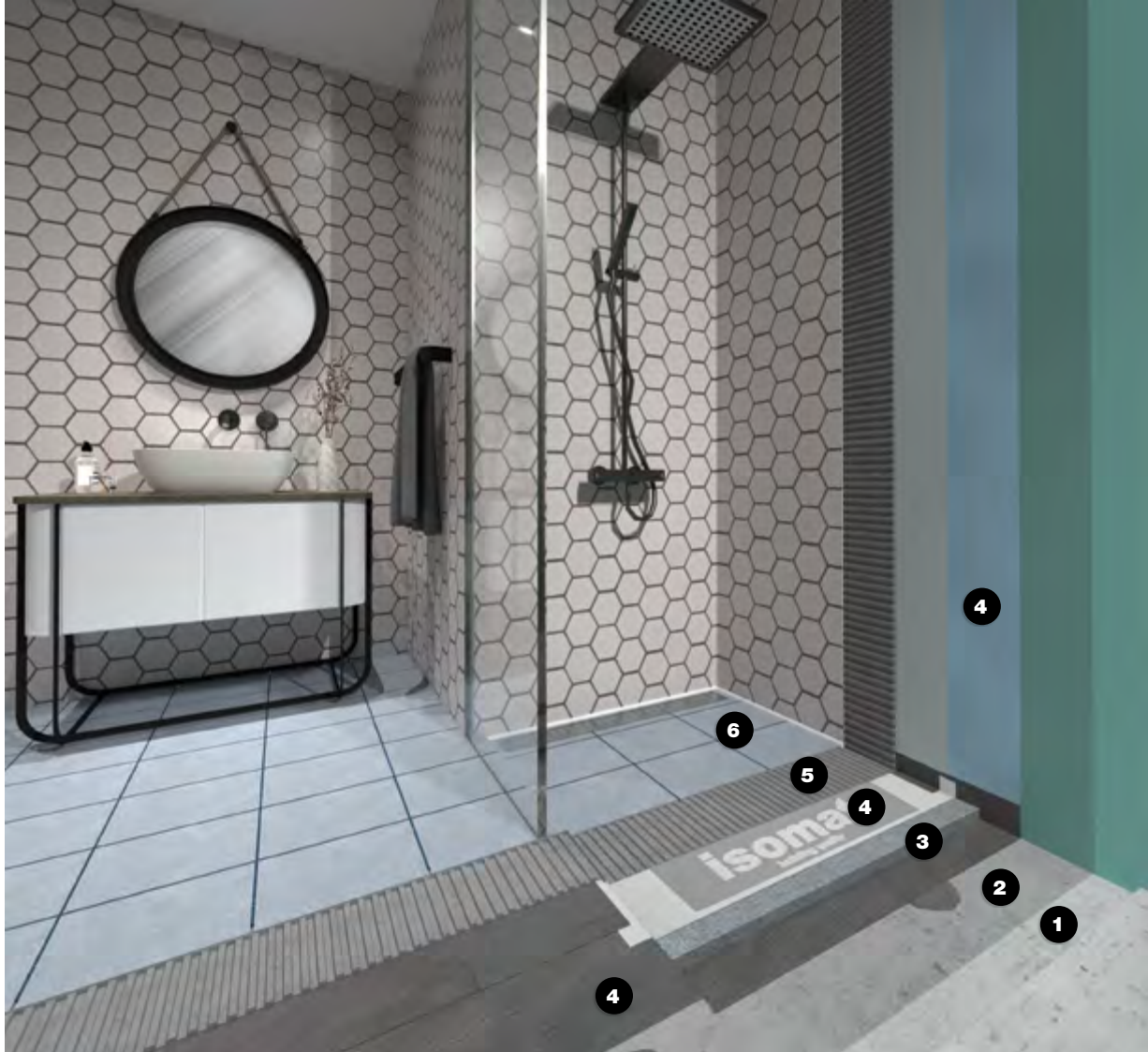
1. UNTERGRUND | 2. GRUNDIEREN | 3. AUSGLEICHEN | 4. ABDICHTEN | 5. VERLEGEN | 6. VERFUGEN
