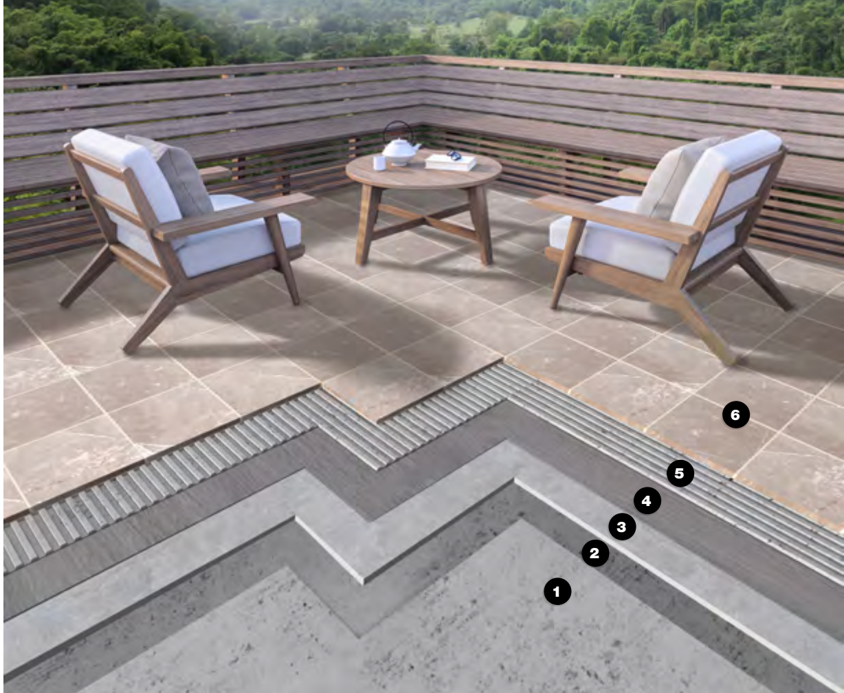
1. UNTERGRUND | 2. GRUNDIEREN | 3. AUSGLEICHEN | 4. ABDICHTEN | 5. VERLEGEN | 6. VERFUGEN
