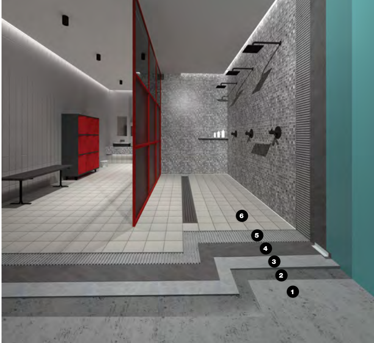
1. UNTERGRUND | 2. GRUNDIEREN | 3. AUSGLEICHEN | 4. ABDICHTEN | 5. VERLEGEN | 6. VERFUGEN
