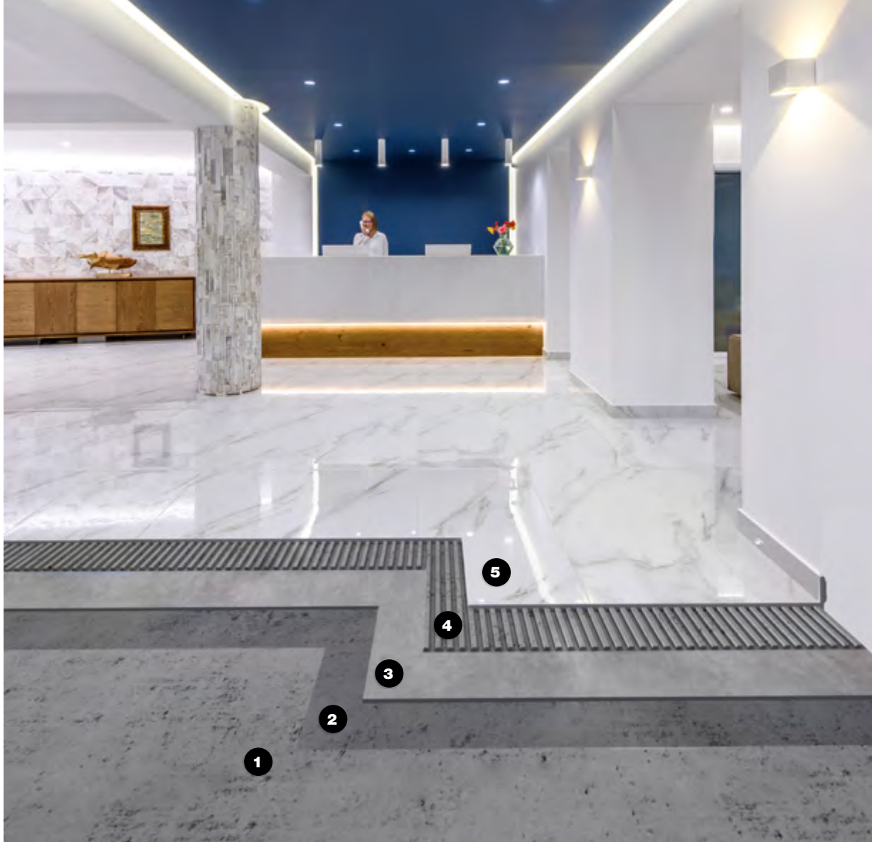
1. UNTERGRUND | 2. GRUNDIEREN | 3. AUSGLEICHEN | 4. VERLEGEN | 5. VERFUGEN
